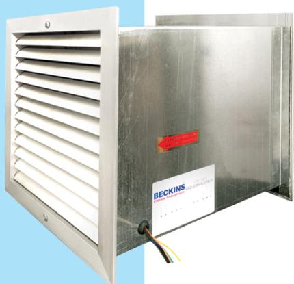
VENTIBEC é uma caixa de ventilação com filtragem acoplada que tem por finalidade insuflar ou exaurir ar de pequenos ambientes. Muito utilizada em locais com ar condicionado tipo Splits onde necessita-se manter a taxa de ar exterior filtrado. Pode ser aplicado também em banheiros, cozinhas e locais onde haja necessidade de renovação de ar. Gabinete fabricado em chapa de aço galvanizada e possui duas grelhas em alumínio anodizado.
