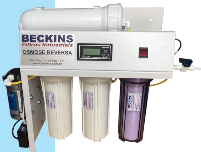
O Desmineralizador (Deionizador) Beckins é constituído por um purificador por osmose reversa e um cartucho desmineralizador descartável com resina mista para troca iônica. A maior parte da desmineralização é feita pelas membranas e o cartucho de resina retém metais e sais residuais.
