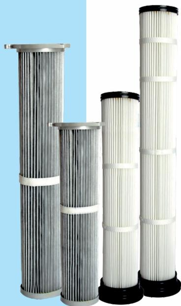
As Mangas Plissadas Beckins são indicadas principalmente para sistemas de despoejamento que utilizam sistema de limpeza (pulse jet). Comparadas com as mangas filtrantes tradicionais, as mangas plissadas consomem 40% menos ar comprimido e possui aumento de até 4 vezes na superfície de filtração. São mais curtas (no máximo 2000 mm), o que evita o desgaste por abrasão que as mangas longas sofrem por estarem com os fundos expostos na entrada da corrente de gás.
